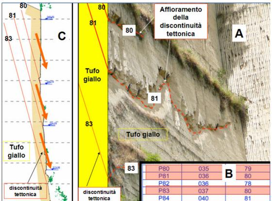
A destra (schema A) sono rappresentate le discontinuità numerate e misurate dall'ARPAC (lo schema B indica il numero della frattura; il numero a destra indica l'inclinazione della discontinuità). La sezione a sinistra il reale assetto interno del tufo con l'andamento a franapoggio meno inclinato delle fratture rilevate anche dall'ARPAC; tale sezione è la correzione delle errate sezioni ARPAC
