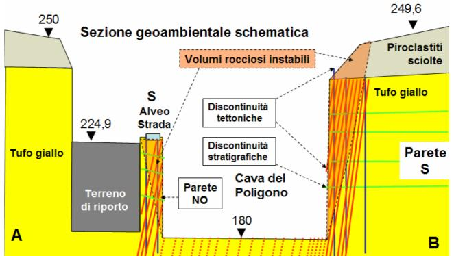
Sezione geoambientale che evidenzia le più gravi e pericolose instabilità della Cava del Poligono lungo la parete sud e NO. Tali evidenti situazioni non sono state comprese dai progettisti della discarica.
