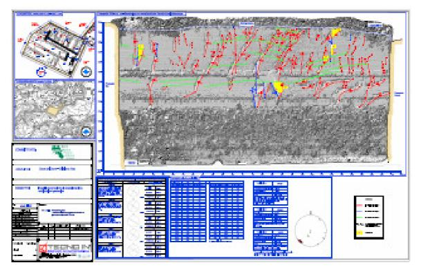
Rilievo Laser Scanner della parete sud effettuato dall'ARPAC. Le linee rosse rappresentano le molte fratture immergenti verso valle che individuano prismi di tufo instabili. Le superfici interessano tutto l'ammasso tufaceo penetrando, a franapoggio meno inclinate del pendio, all'interno della parete con inclinazioni comprese tra circa 80 e 85 gradi.
