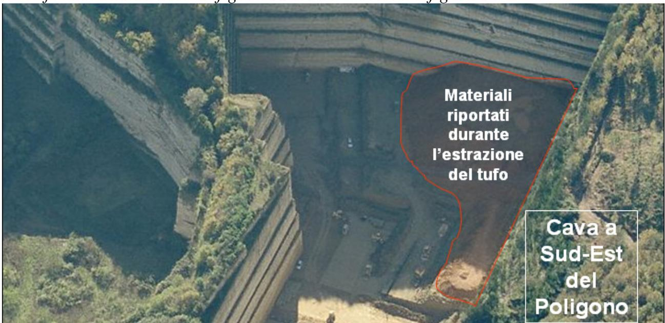
*Figura 18: evidenza delle significative modificazioni ambientali effettuate con l'estrazione del tufo giallo e i successivi sversamenti di materiali nelle cave a sud est del Poligono fino al 2006*
