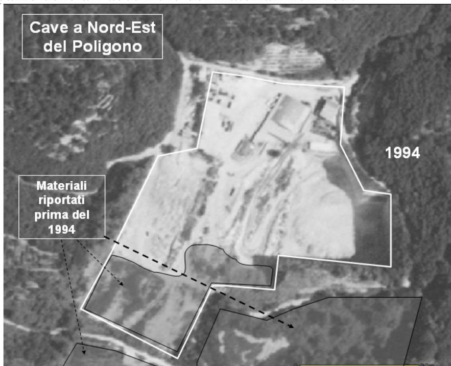
Figura 7: ricostruzione degli sversamenti effettuati prima del 1994 nelle cave a nord est della Cava del Poligono
