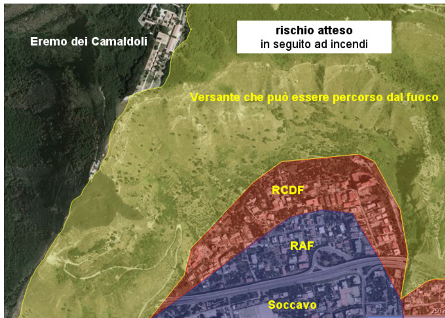
Figura 5: Il rischio atteso dopo gli incendi, non previsto dagli elaborati dell'Autorità di Bacino. RCDF= rischio connesso a scorrimento di flussi detritico-fangosi. RAF= rischio connesso a scorrimento di acqua fangosa.
