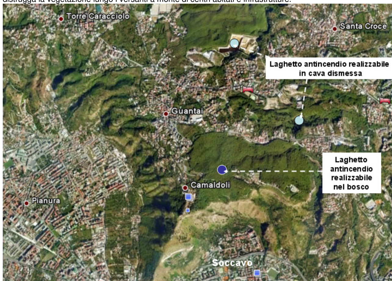
Figura 8: possibili ubicazioni di laghetti antincendio che metterebbero a disposizione dei mezzi a pala rotante e terrestri una riserva idrica sulla sommità dei Camaldoli garantendo rapidi ed efficaci interventi. I laghetti potrebbero essere realizzati a distanza variabile da qualche centinaio di metri a circa 1400 metri dai versanti che incombono su Soccavo e Pianura. Attualmente i mezzi antincendio a pala rotante devono rifornirsi di acqua marina ad una distanza di circa 5 km dai versanti.
