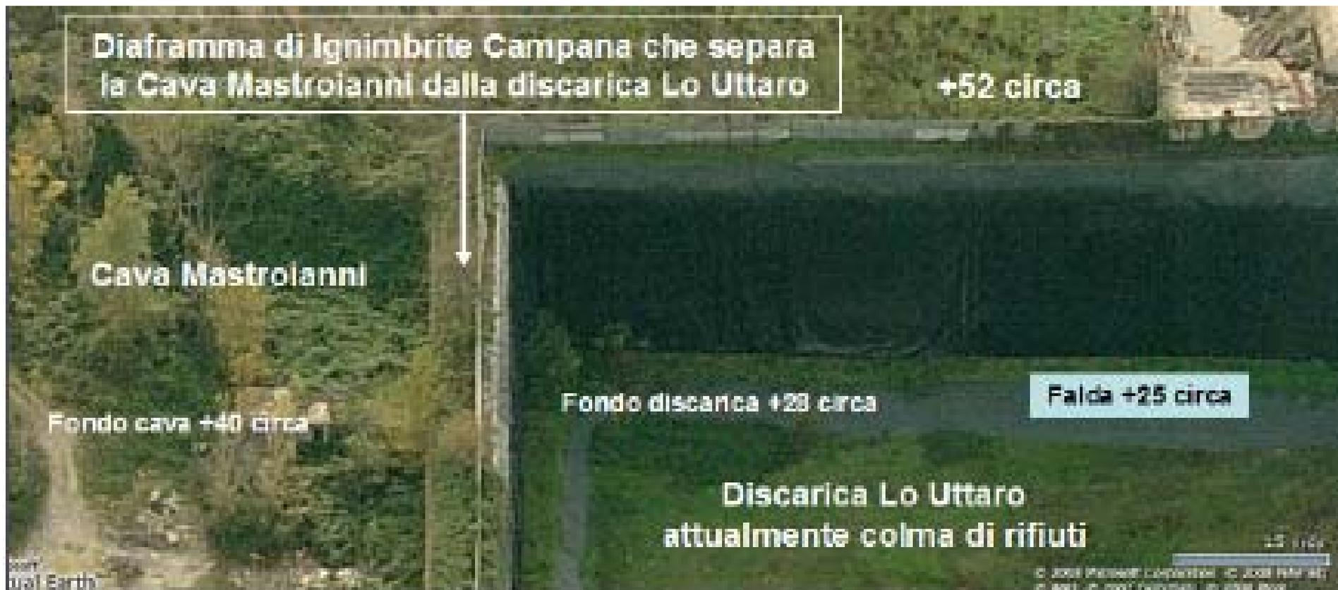
Figura 21: evidenza della diversa quota del fondo della cava Mastrolanni rispetto al fondo della discarica Lo Uttaro prima del completo colmamento avvenuto durante il 2007
