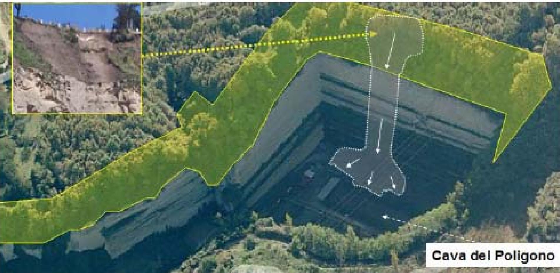
**Parte sommitale del versante (delimitata con il colore giallo trasparente) caratterizzata dall'affioramento delle piroclastiti sciolte poggianti sul Tufo Giallo dalle quali si possono innescare ed evolvere colate di fango (tipo quelle evidenziate nel riquadro) che interesserebbero parte della sottostante cava del Poligono, come schematizzato dall'area in grigio trasparente**
